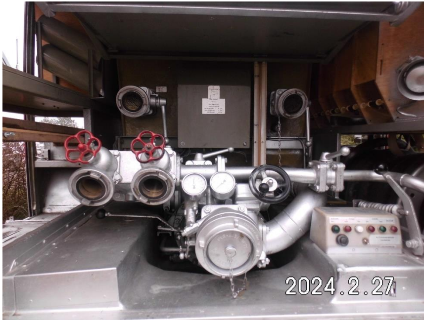
Zdj. 5. Pompa z tyłu pojazdu po kapitalnym remoncie.
